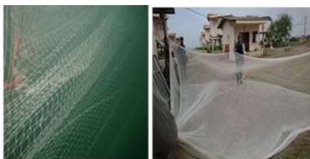
شکل ۳: پاکت مورد استفاده در تحقیق؛ سمت راست: پاکت ساخته شده پیش از نصب، سمت چپ: پاکت در زیر آب (با استفاده از دوربین‌های زیر آبی)
